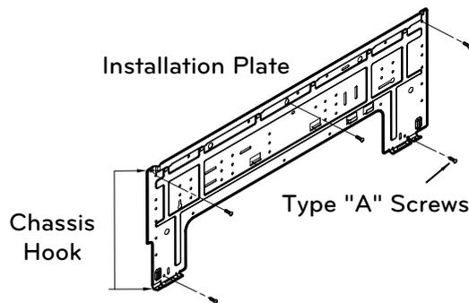
Figure 18: Installation Plate - 180HEV, 240HEV
