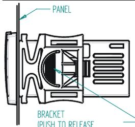
Los instrumentos deben ser montados en panel, en una perforación de 29x71 mm, y fijados usando las fijaciones que se acompañan. La temperatura ambiente en torno al instrumento debe estar en el rango 0÷60 °C para una correcta operación del aparato. Evite lugares sujetos a fuertes vibraciones, gases corrosivos, suciedad excesiva o humedad. Las mismas recomendaciones se aplican a las sondas. Déjese circular aire a través de las rendijas de enfriamiento.
