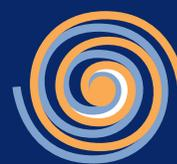
**4** El gas es comprimido continuamente al centro de los scrolls, en donde se descarga, a través de puertos precisamente mecanizados, al condensador
